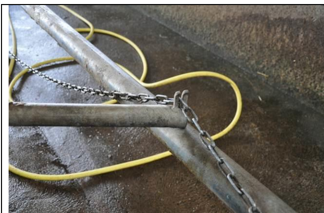
Figur x. En jernkæde sættes i et hak på "fang-røret" så røret låses og holder køerne på plads.
